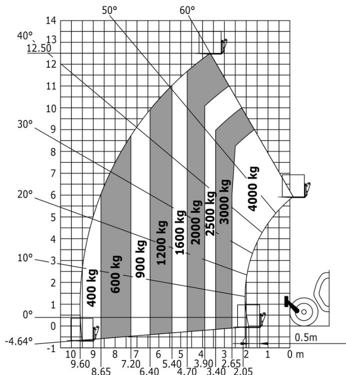
Máquina sobre estabilizadores rebaixados com garfos Metric
